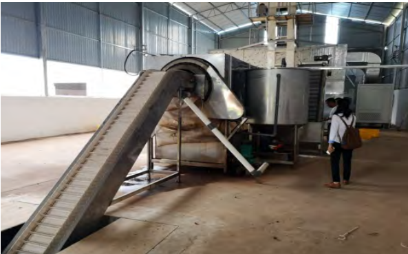
图 22 自动破壳清洗装置设计图及优化实物图
