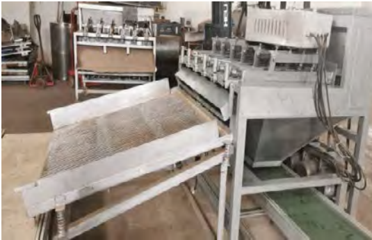
图 21 全自动脱皮机设计图及优化实物图
